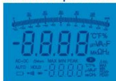
Le grand afficheur LCD double avec rétro-éclairage bleu comporte également un bargraphe pleine échelle 61+2 segments. Le 0 central offre une visualisation immédiate des variations. Ce type de bargraphe est très pratique pour du réglage.
