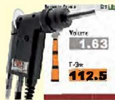
Poignée de sonde chauffée, température contrôlée électroniquement et filtre à suie.
