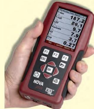
En version "CONFORT" la commande à distance peut être utilisée séparément pour mesurer P.ex. Pressions, températures et détection de fuites.
